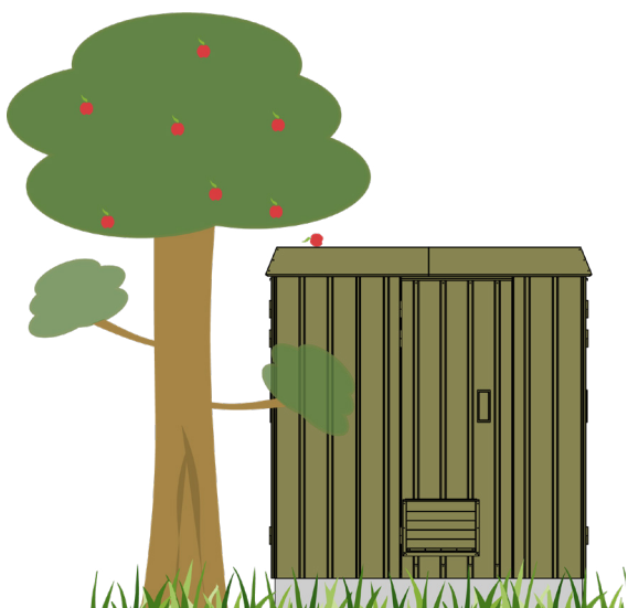
Skitse 1.9 - Eksempel på en station med mekanisk slid på malingsoverflade pga. beplantning.
